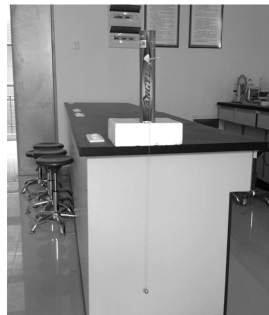
图 5 自制单摆测重力加速度
