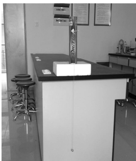
图 4 带有角度仪和刻度仪的单摆支架
