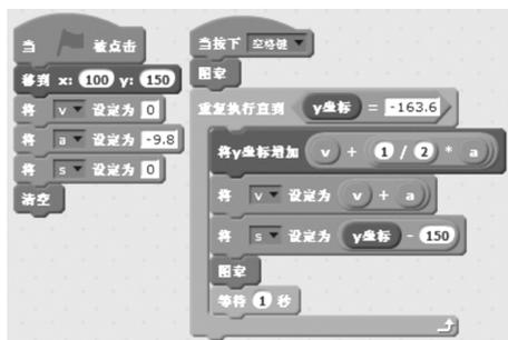
图5 可以记录小球的位置并控制实验速度的自由落体编程模块
