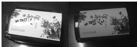
图10 左图不加偏振片,右图加偏振片
