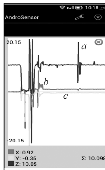
(a) 手机自由下落, 测得的加速度与时间的曲线
