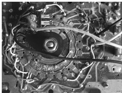
图4 变频开关实物图
