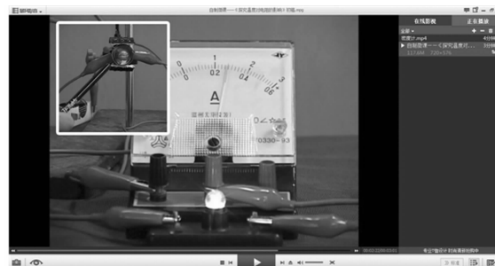
(b) 当撤去酒精灯,灯丝温度降低,阻值减小,电流重新增大
