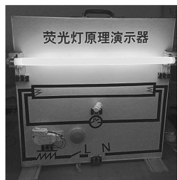
图2 新型荧光灯原理演示器
