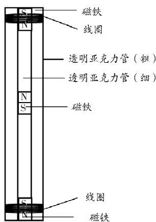
图4 手持式电磁感应演示仪结构示意图
