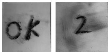
图 1 墨粉在有机玻璃板上显现静电潜影
