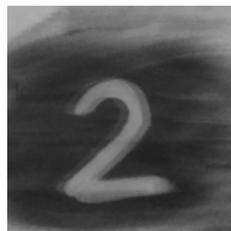
图 2 墨粉在 PP 塑料板上显现静电潜影
