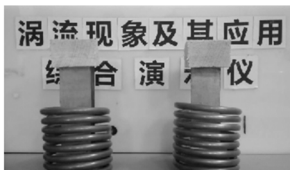
图7 演示减小涡流热效应的方法
