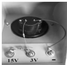
图1 电压表内部线路
