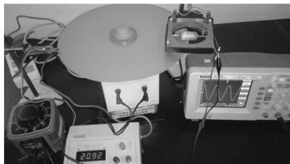
图5 永磁体与运动非磁性导体相互作用的实验装置实物图
