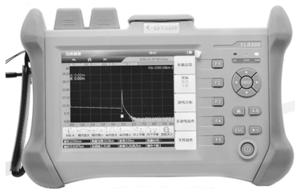
图3 国产 OTDR 仪器图
