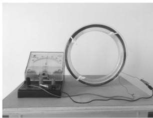
图1 自制磁生电实验装置
