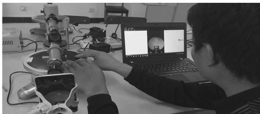
图 2 示教装置观察和调节分光计情景
