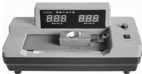
图6 力传感器(电动传送带)——测滑动摩擦力的大小
