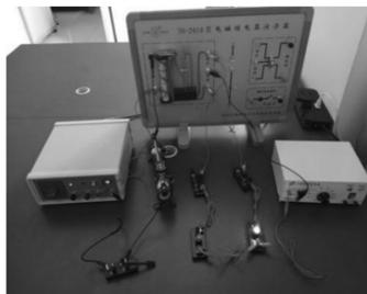
图4 电磁继电器未工作状态下实物图
