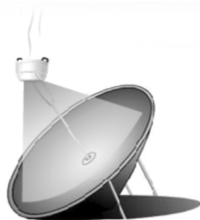
图9 太阳灶的原理
