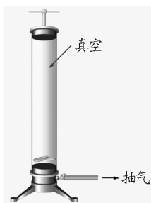
图7 自由落体实验
