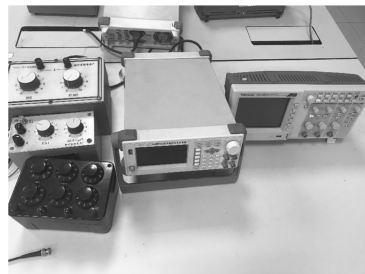
图1 RC/RLC 暂态过程、交流电路和滤波器实验装置
