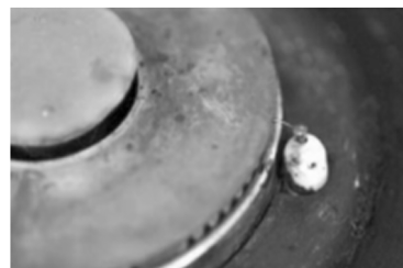
图 9 煤气灶的点火装置
