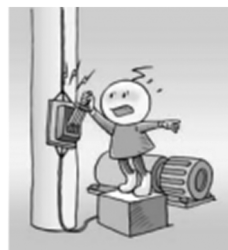
图 10 电路开关断开时,产生电火花
