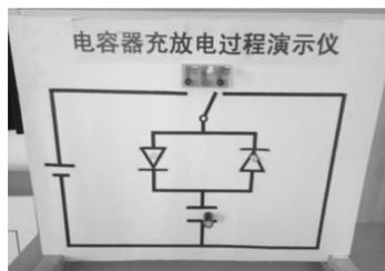
图4 电容器充电放电演示实验
