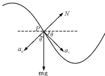
图4 P点受力及加速度图示
