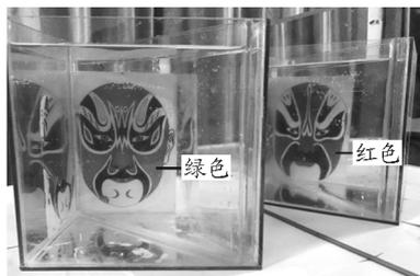
图4 变脸前红、绿光全反射实际效果图
