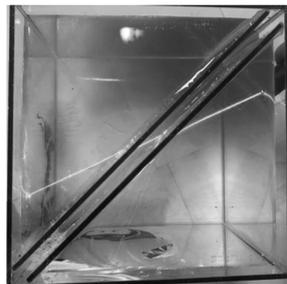
图9 光的全反射变为光的折射
