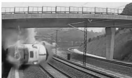
图5 西班牙一列火车超速转弯脱轨
