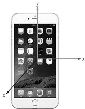
图2 手机传感器 x, y, z 定位方式
