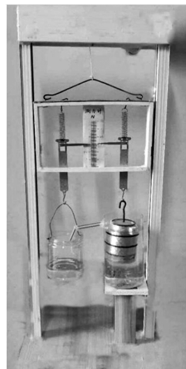
图3 阿基米德原理动态探究实验仪实物图
