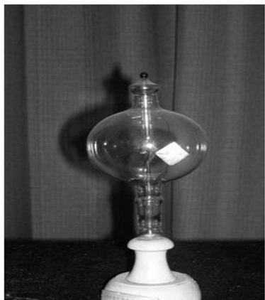
图3 光子风车演示实验装置
