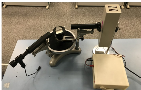
图4 用分光计观察氢原子光谱
