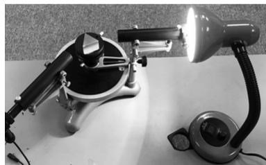
图7 观察白炽灯光谱的实验装置
