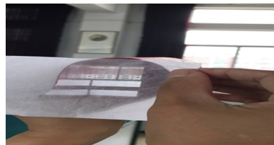
图17 简易照相机成楼房倒立的像
