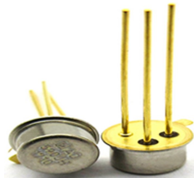
图 1 AD590 集成电路温度传感器
