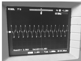
图4 示波器上显示感应电动势波形图
