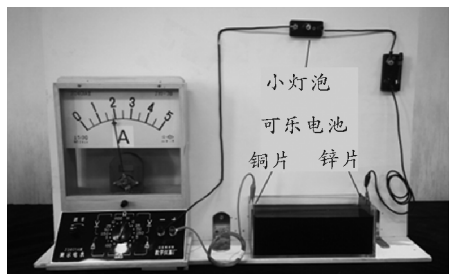
图3 可乐电池演示实验装置图
