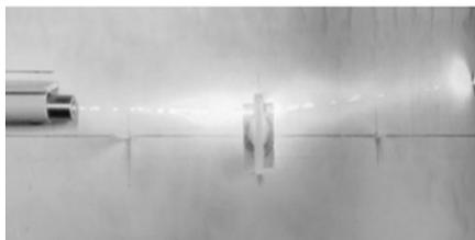
图 8 凹透镜中的光路可逆现象
