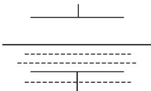
图2 带有电介质流体的平行板电容器
