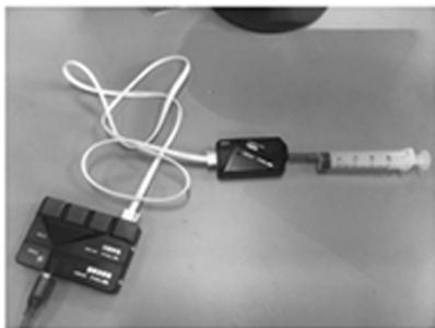
图2 “研究气体压强与体积的关系”实验装置
