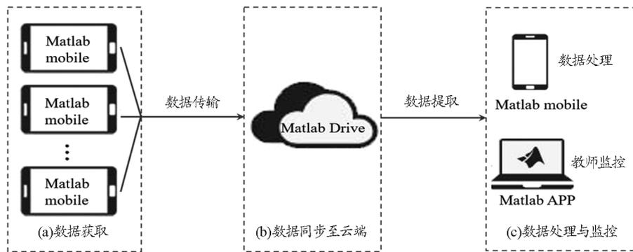
图1 平台结构示意图
