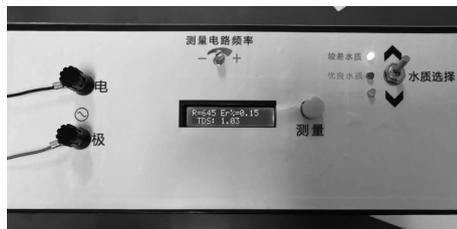
图 8 非平衡电桥水质检测仪面板图
