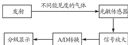
图3 大气能见度监测装置系统图
