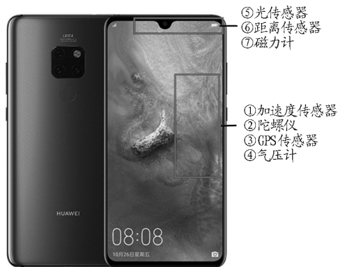
图4 华为手机上部分传感器位置示意图
