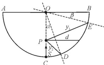
图7 光源向O点移动,弧上光线射出的长度
