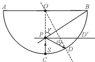
图 5 弧上有光线射出的长度
