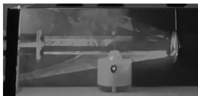
图6 凸面镜对光线的发散作用演示效果
