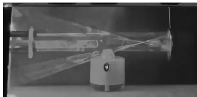
图7 凹面镜对光线的会聚作用演示效果
