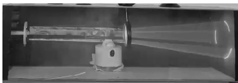
图9 凹透镜对光线的发散作用演示效果
