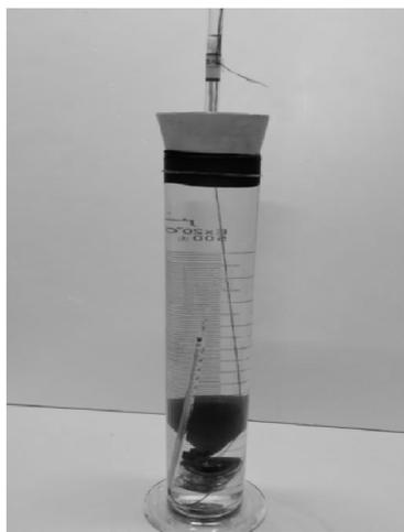
(b) 气球装置处于盛满水的量筒底部, 状态1
