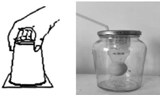
(a) 验证大气压实验示意图 (b) 验证大气压存在改进实验
