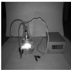
图 1 用温度传感器来测量温度
