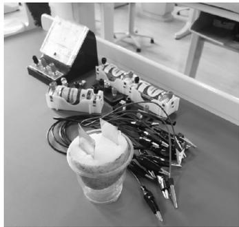
图3 分组测量土豆两端电压实验器材图
