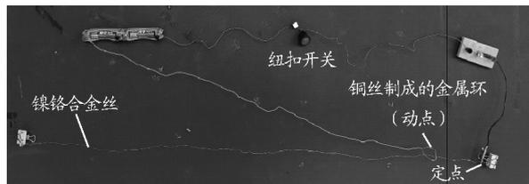
图 3 “用镍铬合金丝控制小灯泡的亮度”实验装置
