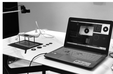
图2 基于 OpenCV 图像识别技术的 PTC 恒温加热平台
