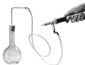
图2 空气推动塞子,内能减小
