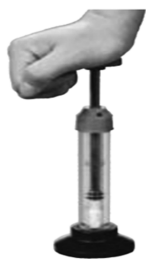
图1 空气被压缩,内能增大
