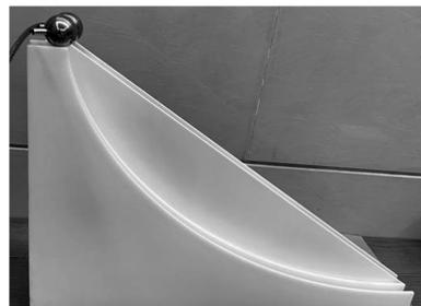
图3 最速降线 3D 打印实验装置实物图
